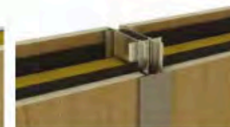
Remplissage BF13 + plaque massouple acoustique + laine de verre 45 mm.
